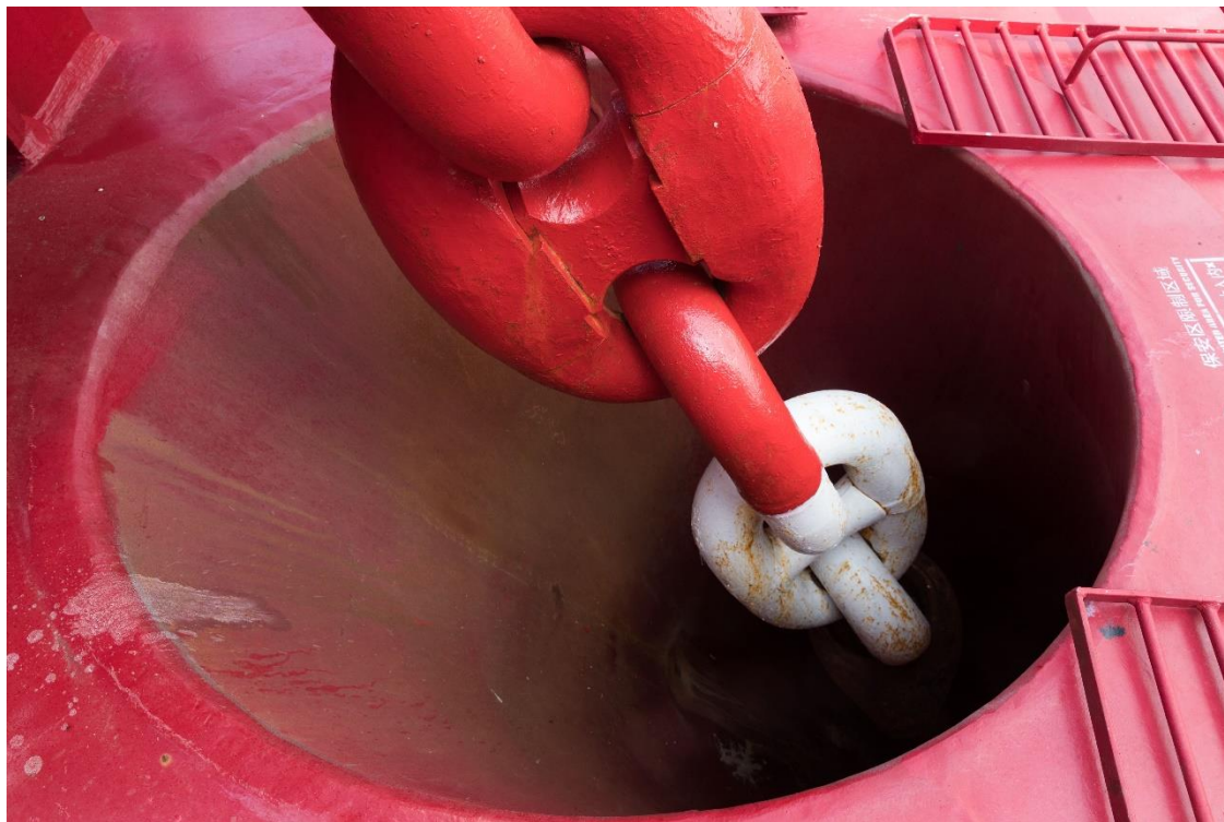
锚链连接链环于锚链筒内
