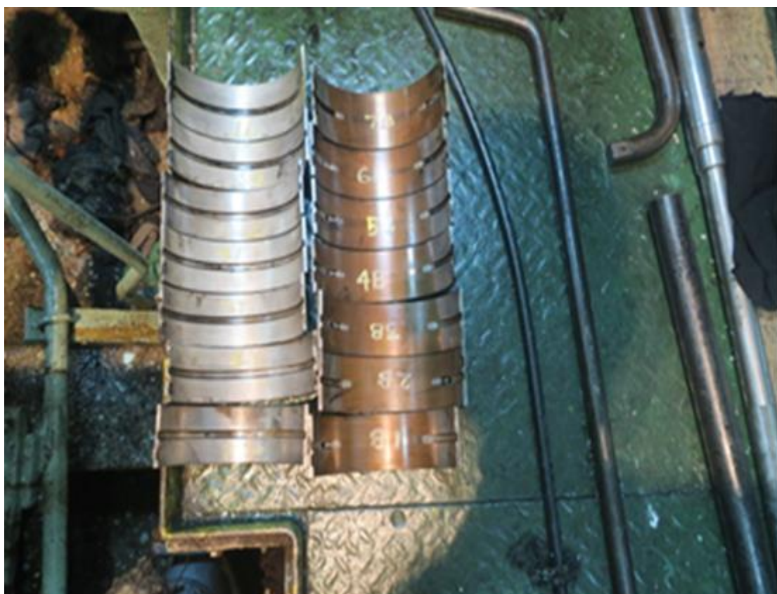
损坏的连杆大端轴瓦
