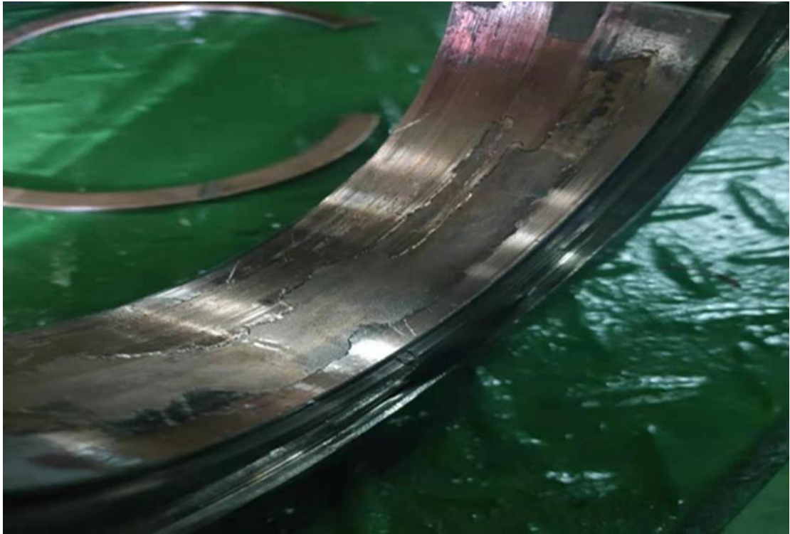
损坏的连杆大端轴瓦
