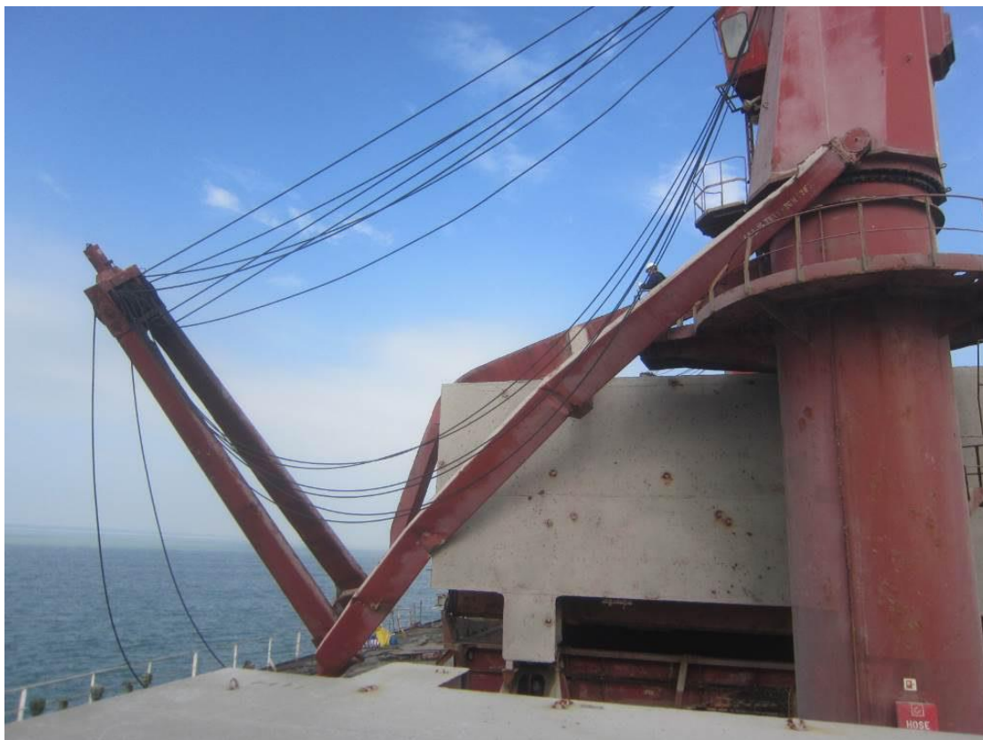
船舶克令吊吊臂受损折断
