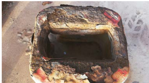
锈蚀严重的底座
