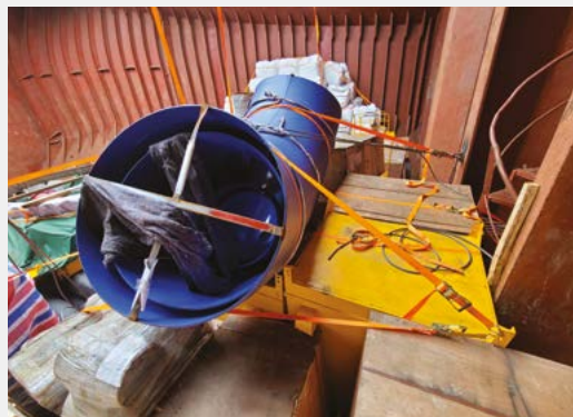
船体系固点强度不够和/或货物上系固点强度不够
