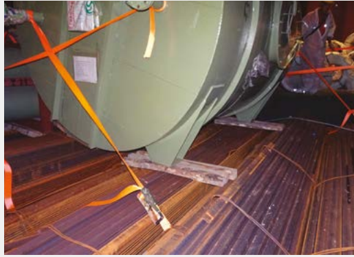
绑扎数量不足够、绑扎材料尺寸不合适以及绑扎角度不合适
