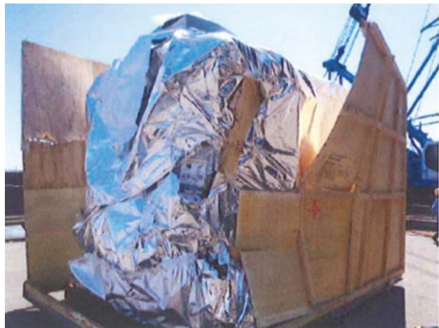
包装不良导致损坏
