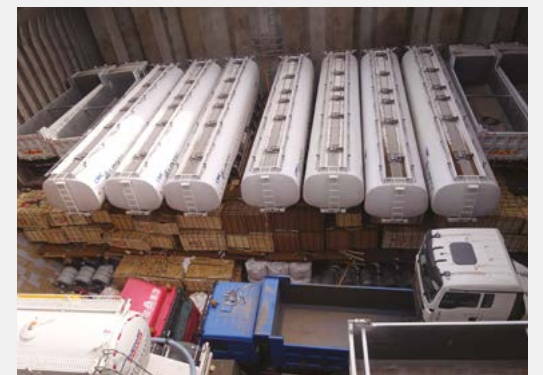
轮载货物或重型货物装在袋装货物或基础不稳的货物上面
