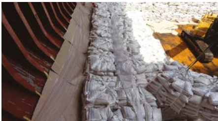
袋装大米使用泡沫板、塑料薄膜为垫舱材料
