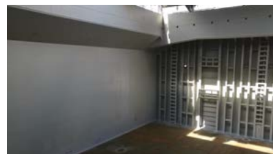
上图:易出汗的单层船壳 下图:不易出汗的双层船壳
