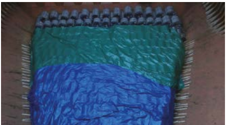
遮盖货物避免汗水滴落到货物表面
